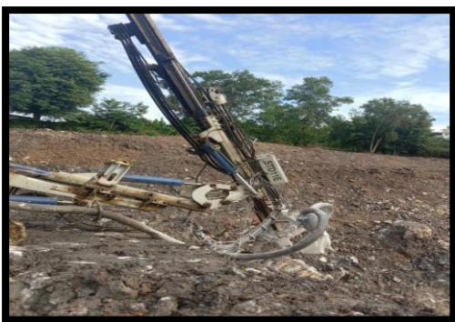
รูปที่ 2-30 รถเจาะแร่มีเครื่องดักเก็บฝุ่น
